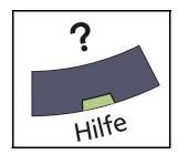
Um die Hilfefunktion einzublenden, drücken Sie die **Hilfe** Taste auf dem Bedienfeld. Die Hilfefunktion zeigt Erklärungen zu den möglichen Funktionen.
