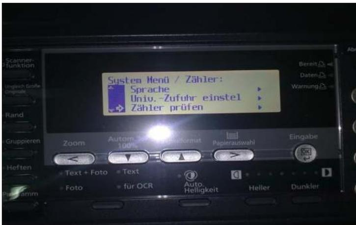
Nun drücken sie erneut die Taste (Pfeil nach Unten“Automat. 100 %“) bis der linke Pfeil im Display auf „Zählerreport drucken“steht, dann die „OK“ Taste drücken – nun wird ein Zählerbericht gedruckt ..
