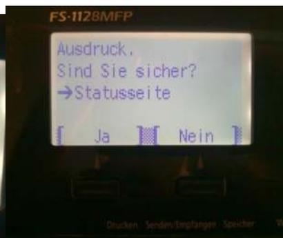
Nun drücken Sie die Taste unterm Display wo „Ja“ steht und es wird ein Bericht gedruckt.....
